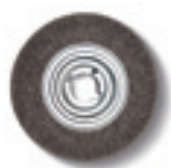
Szczotka stalowa Ø 250 mm x 60 mm, bardzo duża wytrzymałość drutu na zerwanie, bardzo ekonomiczna w zastosowaniu, otwór do mocowania Ø 51 mm. Grubość drutu 0,2 mm do cienkościennych rur i profili. Grubość drutu 0,35 mm do uniwersalnego zastosowania. Grubość drutu 0,5 mm do grubościennych rur i profili, duża wydajność usuwania zadziorów. Wykonanie ze stali
