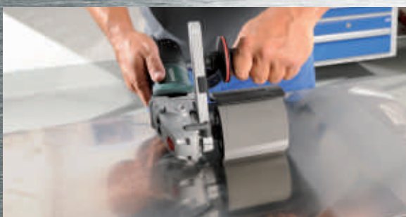
Przygotowanie do polerowania: za pomocą wałka rozprężnego oraz taśmy szlifierskiej Metabo Pyramid o ziarnistości P 2000 (A6).
