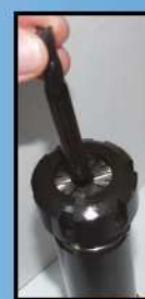
Fot.7. Umieszczanie narzędzia w oprawie
