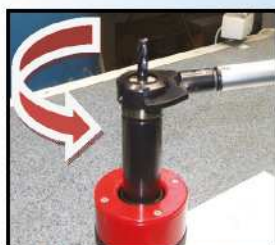
Fot.10. Odkręcanie nakrętki kluczem dynamometrycznym
