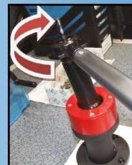
Fot.9. Dokręcanie nakrętki kluczem dynamometrycznym
