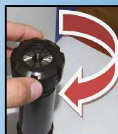
Fot.6. Wstępne skręcenie tulejki z oprawką
