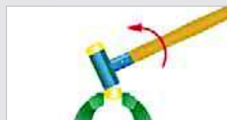
Specjalne, metalowe wypełnienie bijaka umożliwia bezodrzutowe przybijanie.
