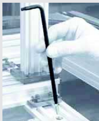
Ponieważ zakleszczenie funkcjonuje czysto mechanicznie, MagicSpring® przytrzymuje mocno i pewnie również wkręty TORX® oraz TORX PLUS® z aluminium, stali nierdzewnej, tworzywa sztucznego i tytanu.
