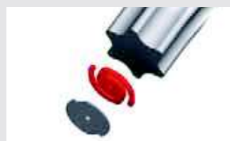
Całkowicie nowatorskim rozwiązaniem jest pióro podtrzymujące, jest ono pozycjonowane razem z tarczą przykrywającą na końcówce trzonu i laserowo zespawane.
