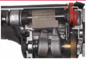
Mechanizm przeciwwagi zapewnia małe drgania - 12.5 m/s²
