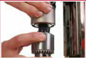
Beznarzędziowy uchwyt Weldon 19 mm
